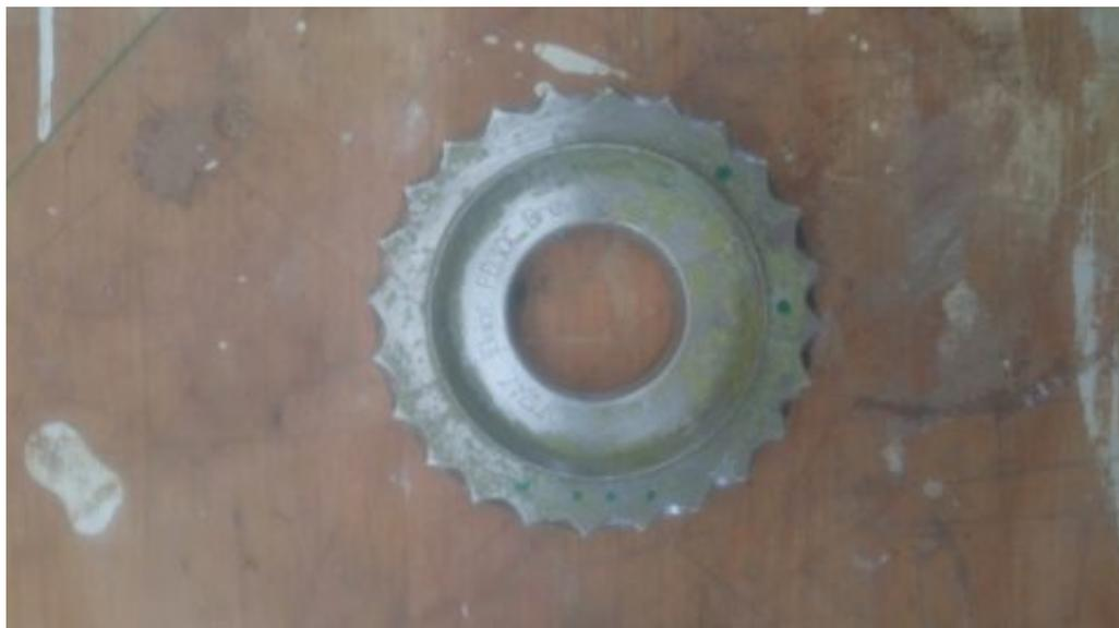
Ce petit machin a pour rôle de couper les ficelles et cordages qui auraient le mauvais goût de s'approcher de l'hélice avant qu'ils ne bloquent l'hélice et déclenchent de la casse sur le moteur.
