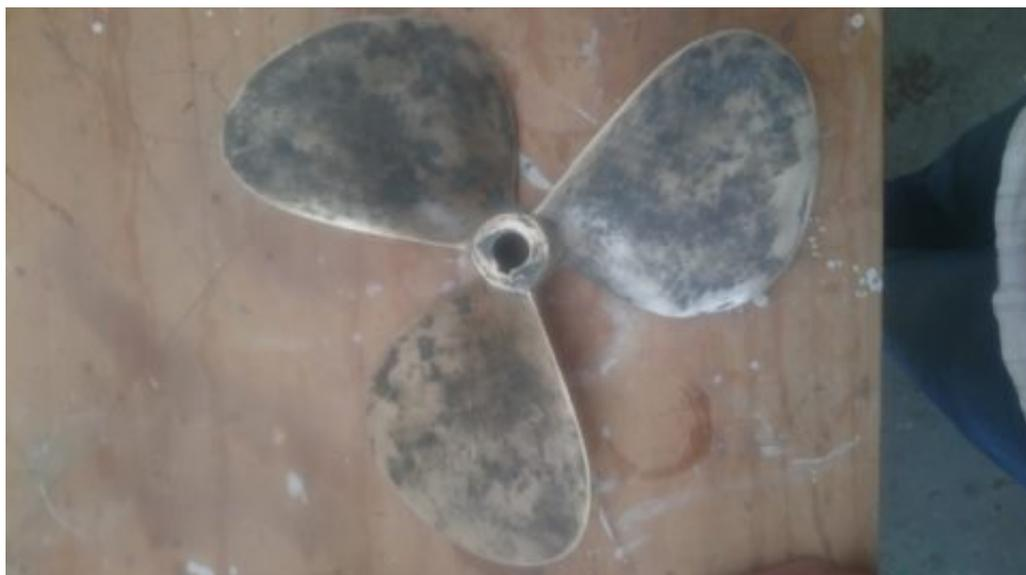
Pas super facile de poncer une surface courbe, mais c'était un luxe de poncer l'hélice démontée plutôt que montée sur le bateau, les bras en l'air, avec beaucoup plus d'endroits difficiles d'accès !
