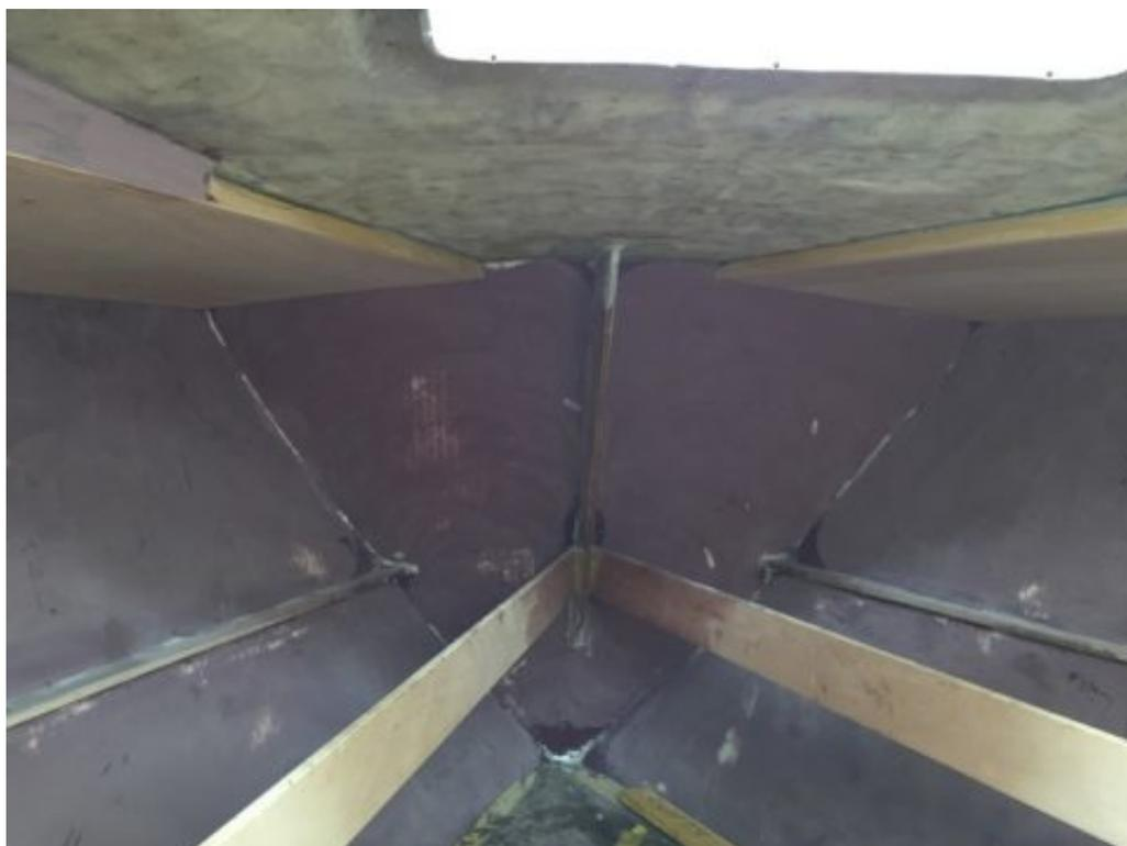
Dans la cabine avant (celle des enfants), toutes les parois sont isolées, le faux-plafond est en cours. Le hublot des loulous sera équipé d'un super système rideau / moustiquaire intégré dans le faux plafond. Des profils de LED seront placés le long des changements de courbure du plafond pour les couchettes du haut.
