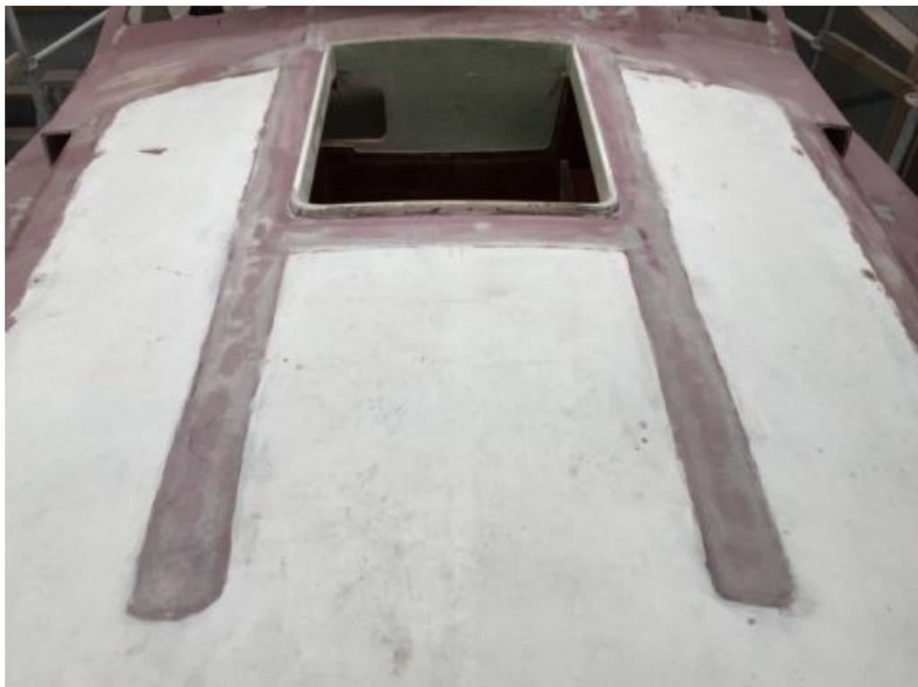
On s'est dit qu'on allait faire un héliport sur le pont. On sait jamais, ça peut servir. Bon en réalité c'est la trace des rails sur lesquels le capot de la descente du carré glissait. On garde le capot et la possibilité de l'ouvrir, mais il ne va plus glisser, donc ouste les rails.
