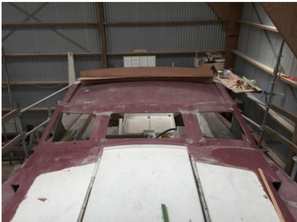
Vue du pont, on voit le creux dans lequel se glisseront des panneaux solaires, qui servira aussi de surface de récupération d'eau de pluie – sans compter qu'on peut se tenir au rebord en passant sur le côté de la capote !
