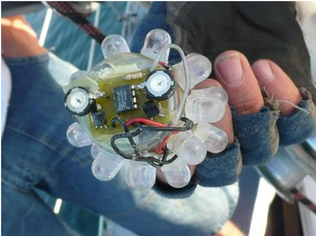
Feu de navigation avec 2 étages de 9 LEDs chacun, en quinconce ... et l'électronique que je pensais faire tenir dans la boîte et en fait non ! C'est la seule photo dont on dispose pour l'instant, on en fera d'autres la prochaine fois qu'on montera au mât !
