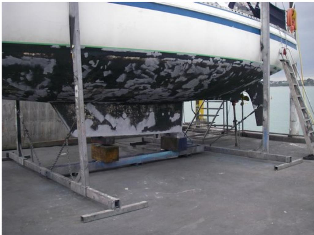
La coque poncée avec des patches de primaire là où on a poncé les cloques du primaire précédent et aux endroits remastiqués
