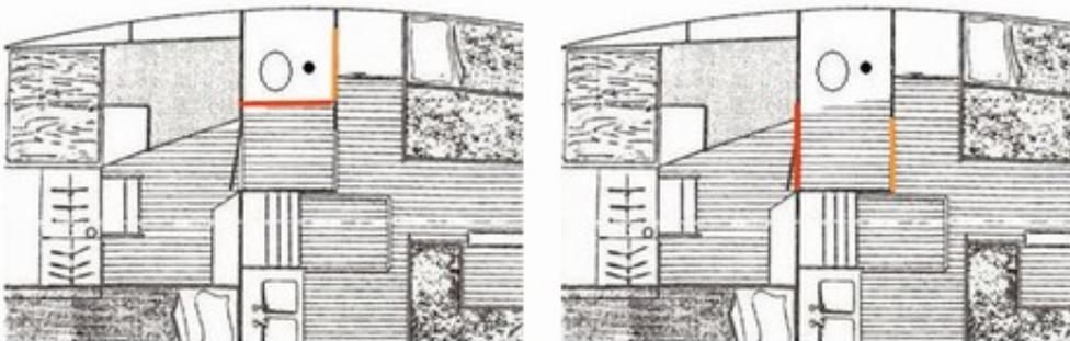
A gauche, les toilettes en position « non utilisées ». A droite, les toilettes occupées : la porte rouge ferme l'accès vers l'arrière, la porte orange coulisse pour fermer l'accès à l'avant. En vrai, les portes ne sont pas rouge et orange...
