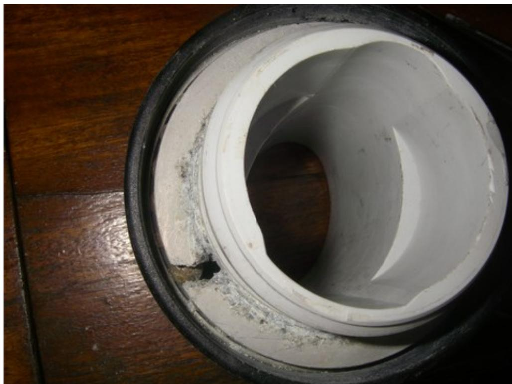
Le gros cercle gris clair avec la fissure, c'est une bague de roulement en aluminium. Cassée. A peu près comme la dernière fois. Avec un peu de persévérance, j'ai fini par réussir à séparer la bague du tambour.
