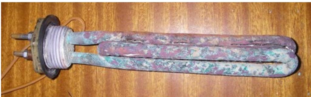
La résistance, enfin ce qu'il en reste. Admirez les fissures permettant à l'eau d'aller directement au contact du fil traversé par le 220V ...
