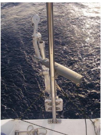
Quand il y a trop peu de vent, que l'on doit suivre précisément un cap compas (près des côtes) ou encore que l'on navigue au vent arrière, Raymond range son aérien et obéit au doigt et à l'œil à Raymonde, qui s'appuie sur un support fixé au mâtereau arrière
