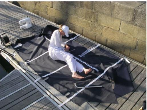
11. Essayer le tout sur le bateau. Tout va bien jusqu'ici, prendre l'apéro pour fêter ça. La mauvaise nouvelle, c'est qu'à partir de maintenant, à chaque fois qu'on va mettre en place provisoirement la capote, il va falloir tendre les sangles, et c'est long... Avec l'aide d'un équipier bienveillant, noter la position des coutures à faire pour assembler le pare-brise et le toit sur les côtés de la capote, le long de l'arceau qui descend.
