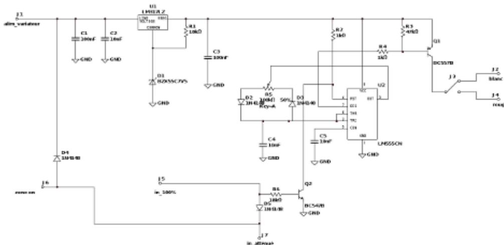
Pour les lampes de cockpit, un module de commande un légèrement modifié est utilisé, car les lampes étant à l'extérieur, j'ai préféré ne pas les doter d'interrupteurs indépendants et tout regrouper sur le boîtier variateur. La commutation des lampes bâbord et tribord est confiée à deux MOSFETs (une fois qu'on a compris comment ça marche et les possibilités offertes par ce type de transistor on a tendance à en mettre partout de ces bidules magiques).
